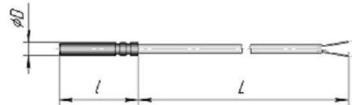
Рисунок 1 – Термопреобразователь в конструктивном исполнении К2
