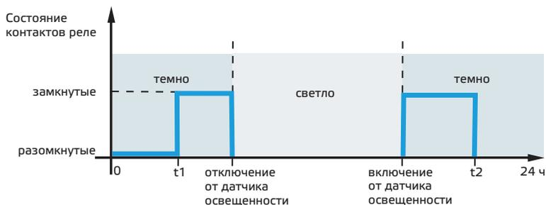
2. Работа таймера (состояние одного из реле) при отключении датчика освещенности, использование нормально-замкнутых контактов реле
