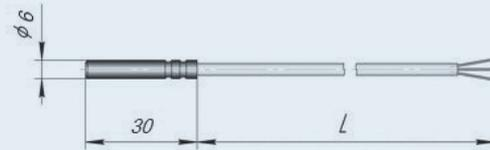
Датчик протечки ДП-1-L, L=2 м.
