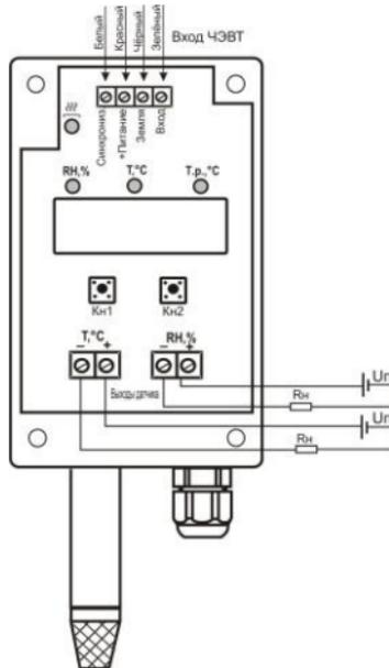
При сопротивлении нагрузки  $R_n$  более 100 Ом (сопротивление линии связи) для определения значения напряжения питания цепи прибора, необходимо учитывать падение напряжения на нагрузке  $R_n$  в соответствии с выражением:
