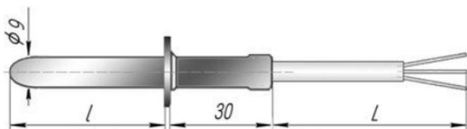
**Рисунок 1 – Внешний вид и габаритные размеры реле температурного РТ–4 в конструктивном исполнении 1**
