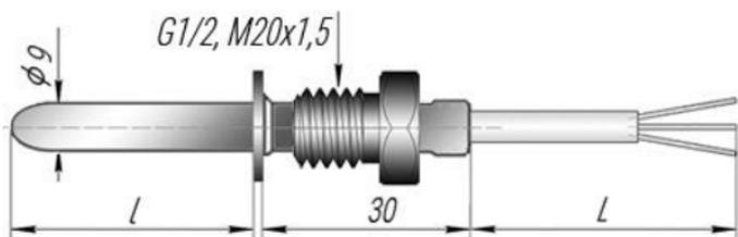
**Рисунок 2 – Внешний вид и габаритные размеры реле температурного РТ–4 в конструктивном исполнении 2**
