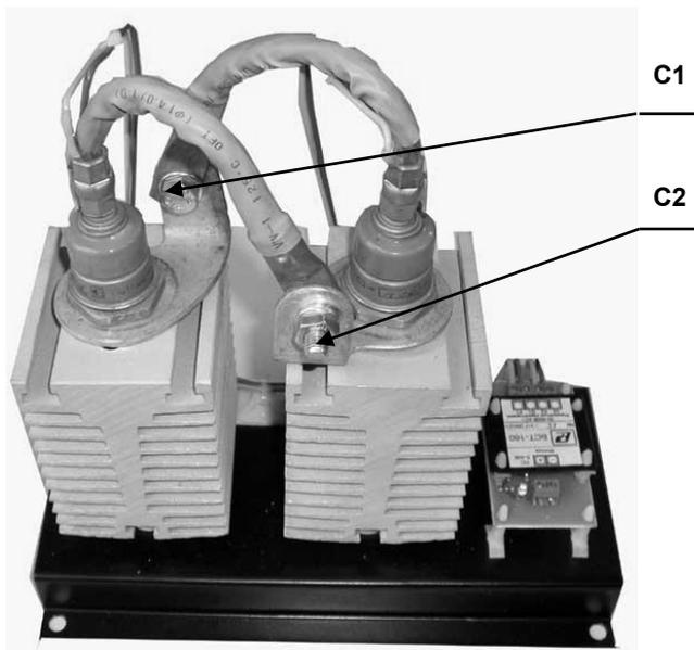
**C1 и C2** – точки соединения анода одного тиристора с катодом другого тиристора, находящиеся на токосъёмной шайбе
